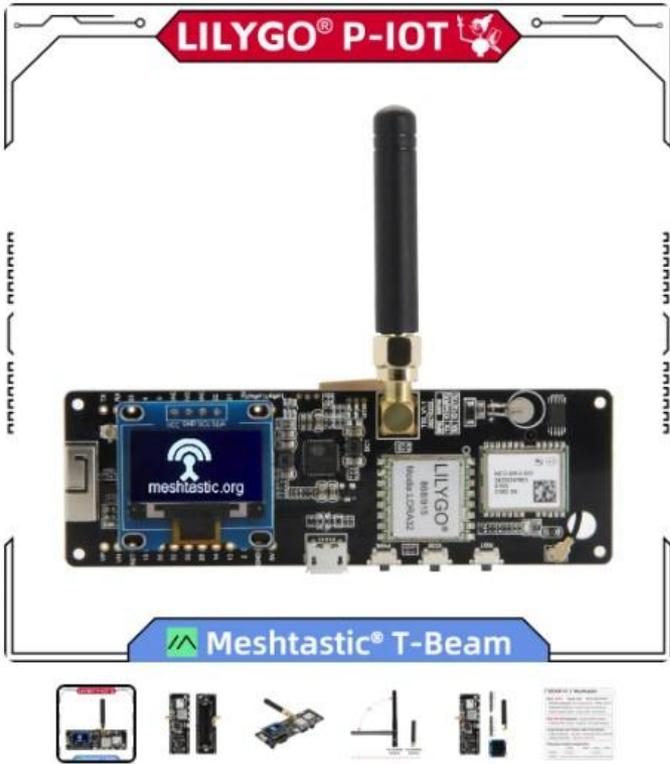
**LILYGO®TTGO Meshtastic T-Strahl V 1,1 ESP32 LoRa 915MHz 433MHz 868MHz 923MHz WiFi BLE GPS mit 0,96 Zoll OLED 18650 Batterie Halter**
