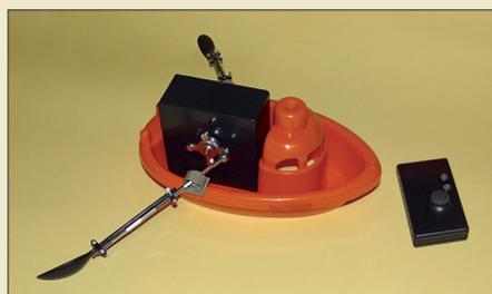
Das hier vorgestellte Modellruderboot ist die Vorstufe eines schwimmenden Roboters, der später vorgestellt wird. Das Boot eignet sich nicht nur in der Sommerzeit durch die Funkfernsteuerung auf Basis von auf 2,4 GHz arbeitenden XBee-Modulen für sportliche Spielereien am Wasser. Foto: Sander 646
