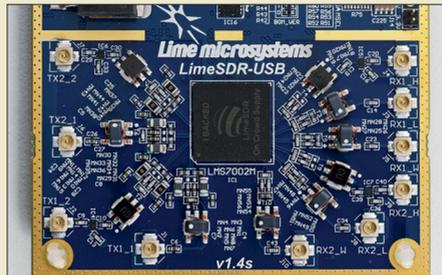
LimeSDR, hier das Eingangsteil, mit seinem Empfangs- und Sendebereich von 100 kHz bis 3,8 GHz bietet eine Darstellungsbandbreite von 2 x 30 MHz. Damit lässt sich etwa der komplette KW-Bereich erfassen, aufnehmen und wie live abspielen. Der Beitrag gibt erste Erfahrungen mit einem Pioniergerät wieder und gewährt einen Blick auf den internationalen Stand der SDR-Technik. Foto: DK8OK 620
